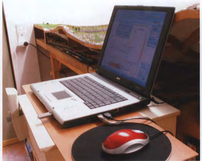
Ein Laptop dient als „Stellwerk“ des Fahrdienstleiters. Im Kasten darunter ist die Digitalsteuerung untergebracht.
