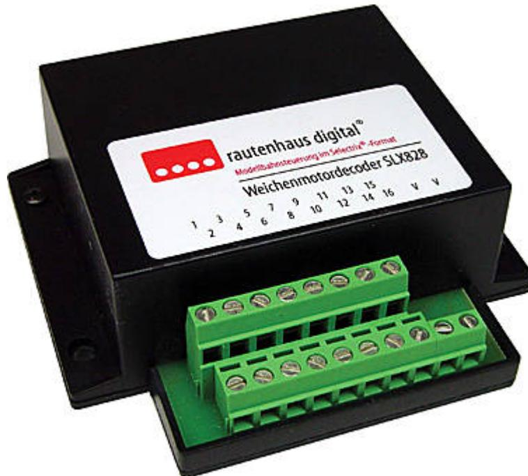
Funktionsdecoder zum Schalten von 8 motorischen Weichenantrieben und anderen motorisch betriebenen Schaltgeräten über eine Systemadresse. Je Ausgang sind max. 2 Motorantriebe anschließbar (z.B. Gleisverbindung mit zwei Weichen). Die Schaltausgänge können als Dauerstrom oder Impulsausgänge gesteuert werden. Im Impulsbetrieb kann die Impulsdauer zusätzlich in Schritten von 0,15ms eingestellt werden.
