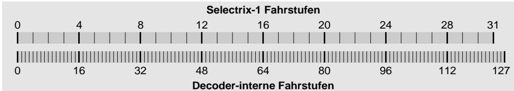
**SelectRIX-2:** Der Decoder unterstützt bei SX2-Betrieb normalerweise 127 Fahrregler-Fahrstufen, die direkt als interne Fahrstufen verwendet werden (Parameter 003 = 112). Dieser Decoder unterstützt auch eine Variante des SX2-Betriebes, mit der nur 31 Fahrstufen des Fahrreglers ausgenutzt werden (Parameter 003 = 000). Die 31 Fahrregler-Fahrstufen werden hierbei, analog zu SelectRIX-1 Betrieb, in die internen 127 Fahrstufen umgesetzt.
